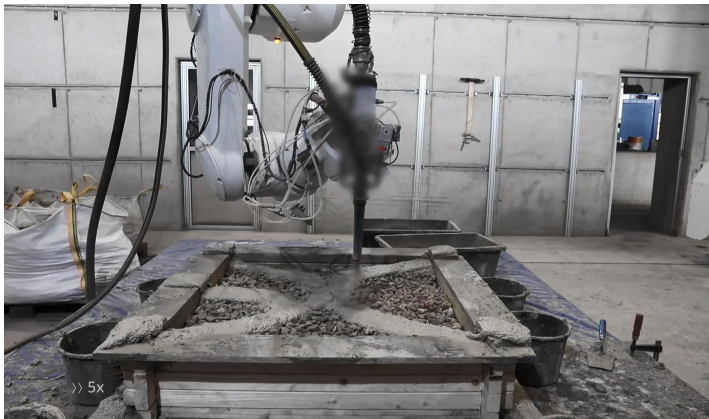
Fragment prezentacji: Prof. Dr. Norman Hack, "The Future of Construction", Zurich 2022: Technische Universität Braunschweig, Robot drukujący beton na warstwach gruzu, 2022
