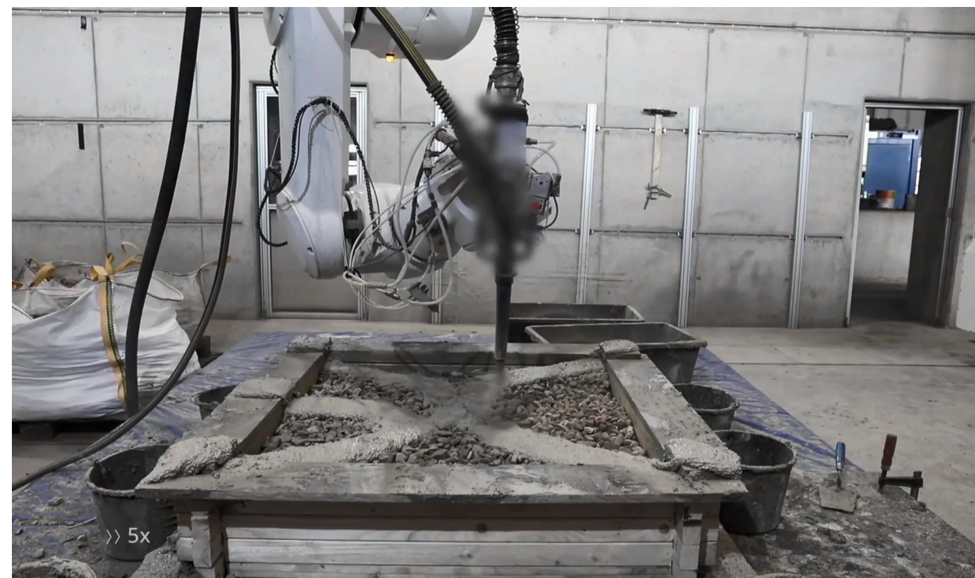
Fragment prezentacji: Prof. Dr. Norman Hack, "The Future of Construction", Zurich 2022: Technische Universität Braunschweig, Robot drukujący beton na warstwach gruzu, 2022
